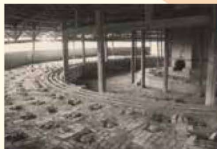
窯上部(2階)と投炭孔の様子
